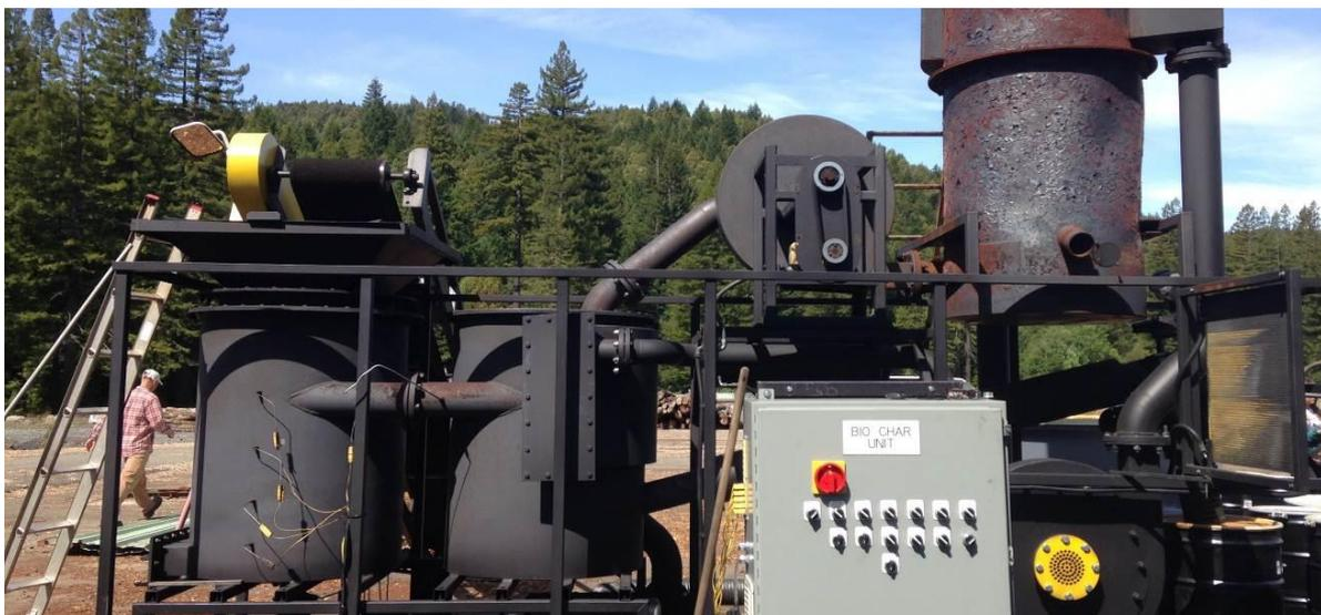
**Abbildung 11: Maschine zur Herstellung von Holzkohle**
